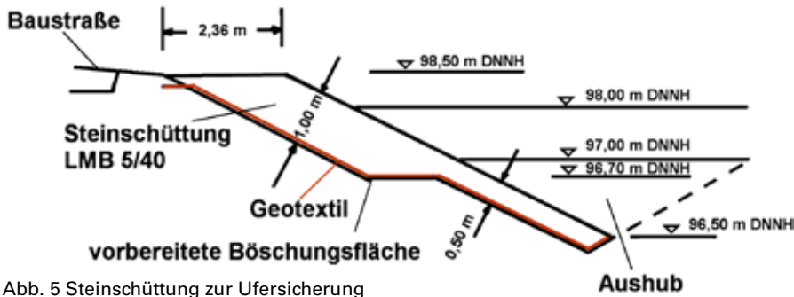
Abb. 5 Steinschüttung zur Ufersicherung
